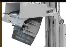
**Préhension, rotation et basculement de fûts, de bobines et d'autres objets**
