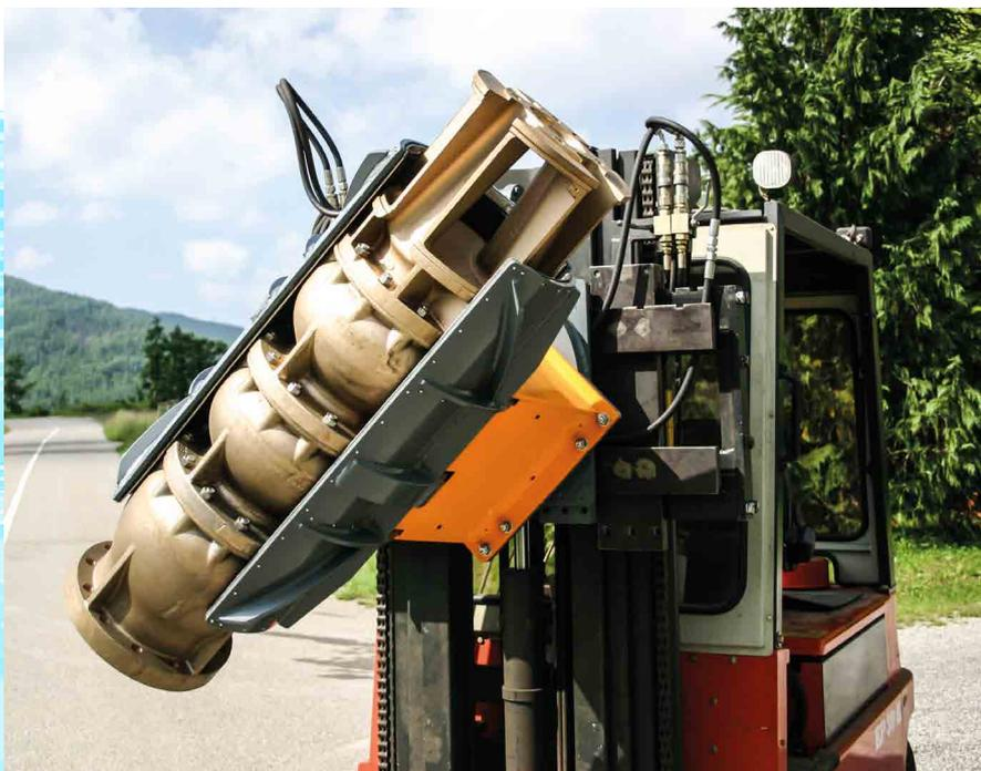
Ces équipements permettent le transport, la rotation et le basculement de récipients et d'autres objets de tout type et de toute mesure.
